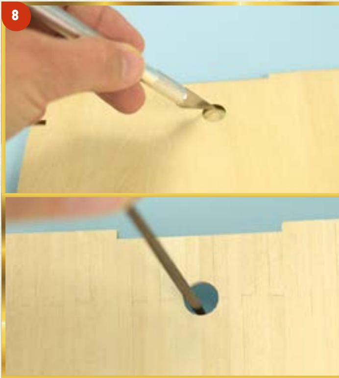
**8** С помощью модельного ножа обрежьте планки так, чтобы они не закрывали отверстие фордека, предназначенное для фок-мачты. Далее обработайте края отверстия надфилем.
