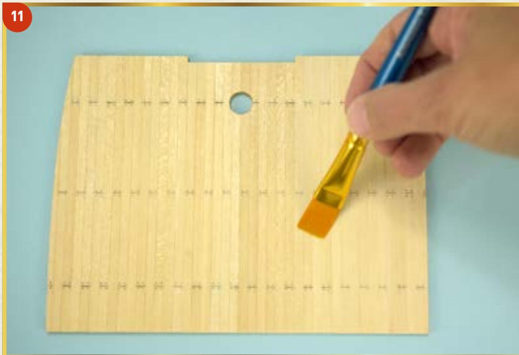
**11** Изобразите шляпки гвоздей вдоль стыков планок на передней части фордека. В завершение осторожно обработайте наждачной бумагой палубный настил и покройте его одним слоем матового бесцветного лака.
