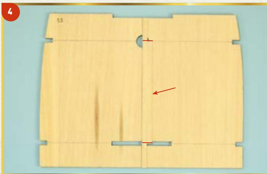
**3** Отрежьте фрагмент планки 0,5 x 4 x 300 мм нужной длины и приклейте его к правой стороне фордека, вдоль продольной осевой линии. Наждачной бумагой обработайте концы приклеенной планки: они не должны выступать за края палубы.
