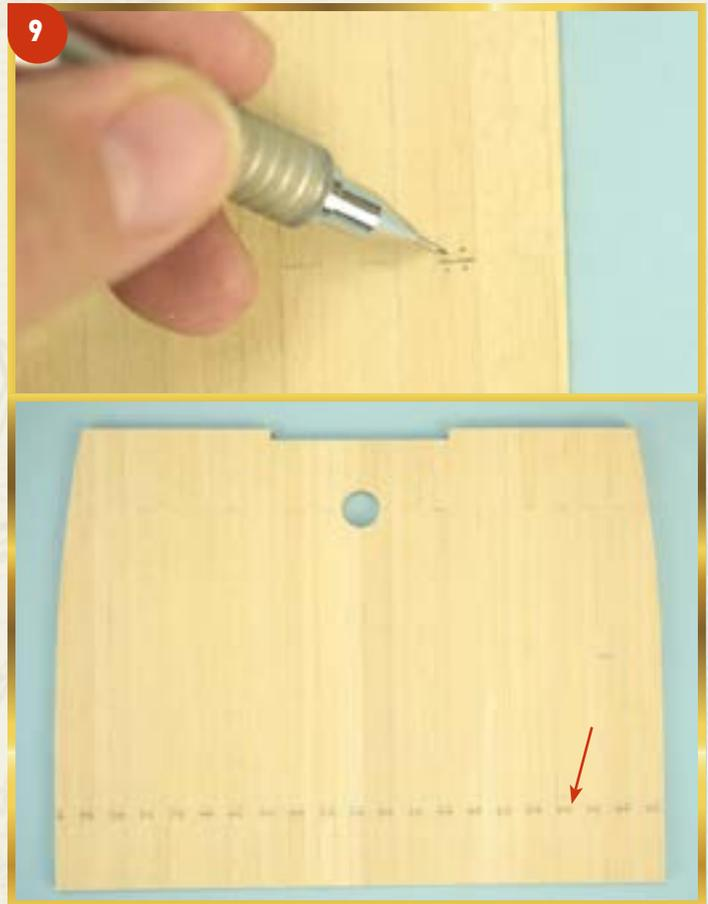
**9** Карандашом выделите стыки планок, а затем симметрируйте шляпки гвоздей. Начните с коротких планок на задней части палубы.
